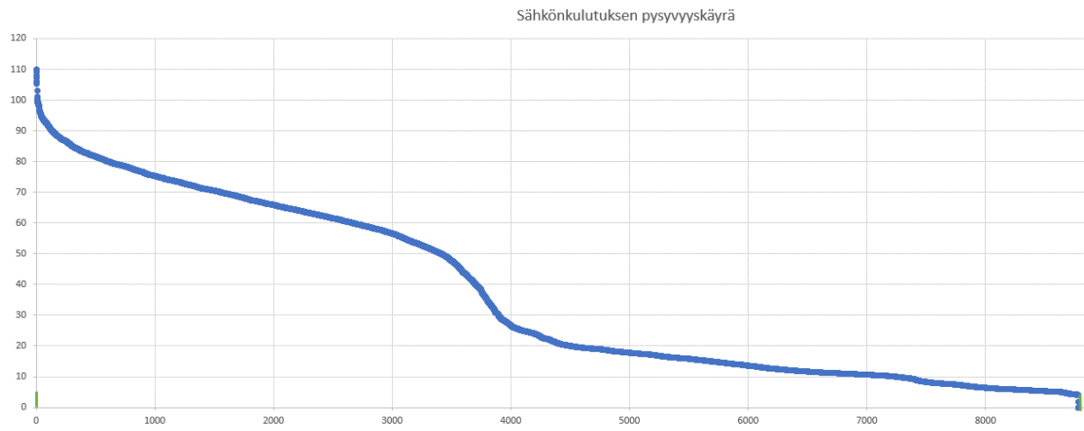
Kuva 23. Kuvassa esitetään graafisesti yrityksen sähkönkulutuksen pysyvyyskäyrä vuonna 2020 (Kuva: Mika Keski-Luopa)
